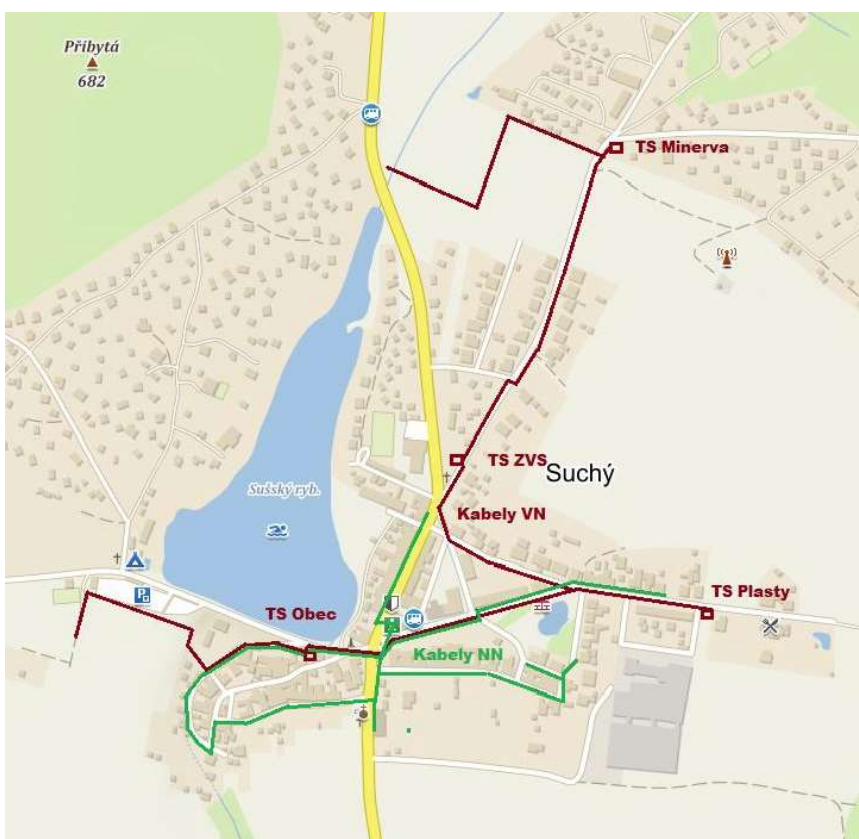
Trasy nového vedení elektrické energie v hladinách nízkého (zeleně vyznačeno) a vysokého napětí (červeně vyznačeno)
